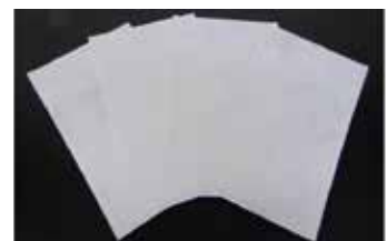
纺粘型 HDPE 高密度聚乙烯包装在 EO 灭菌中具有良好的效果。
